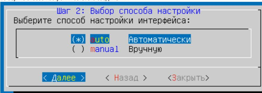
Автоматическая конфигурация интерфейса производится по протоколу DHCP. Возможно выполнение настройки вручную. При выборе автоматической настройки система самостоятельно установит соединение:
