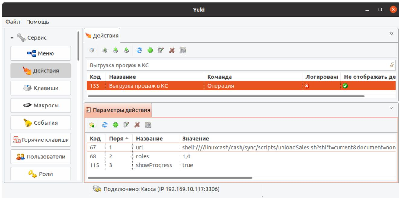
Отображение прогресс-бара при выгрузке продаж в КС задается параметром showProgress. Подробнее о параметрах команды COMMAND\_OPERATION можно прочитать в разделе "Команды".
