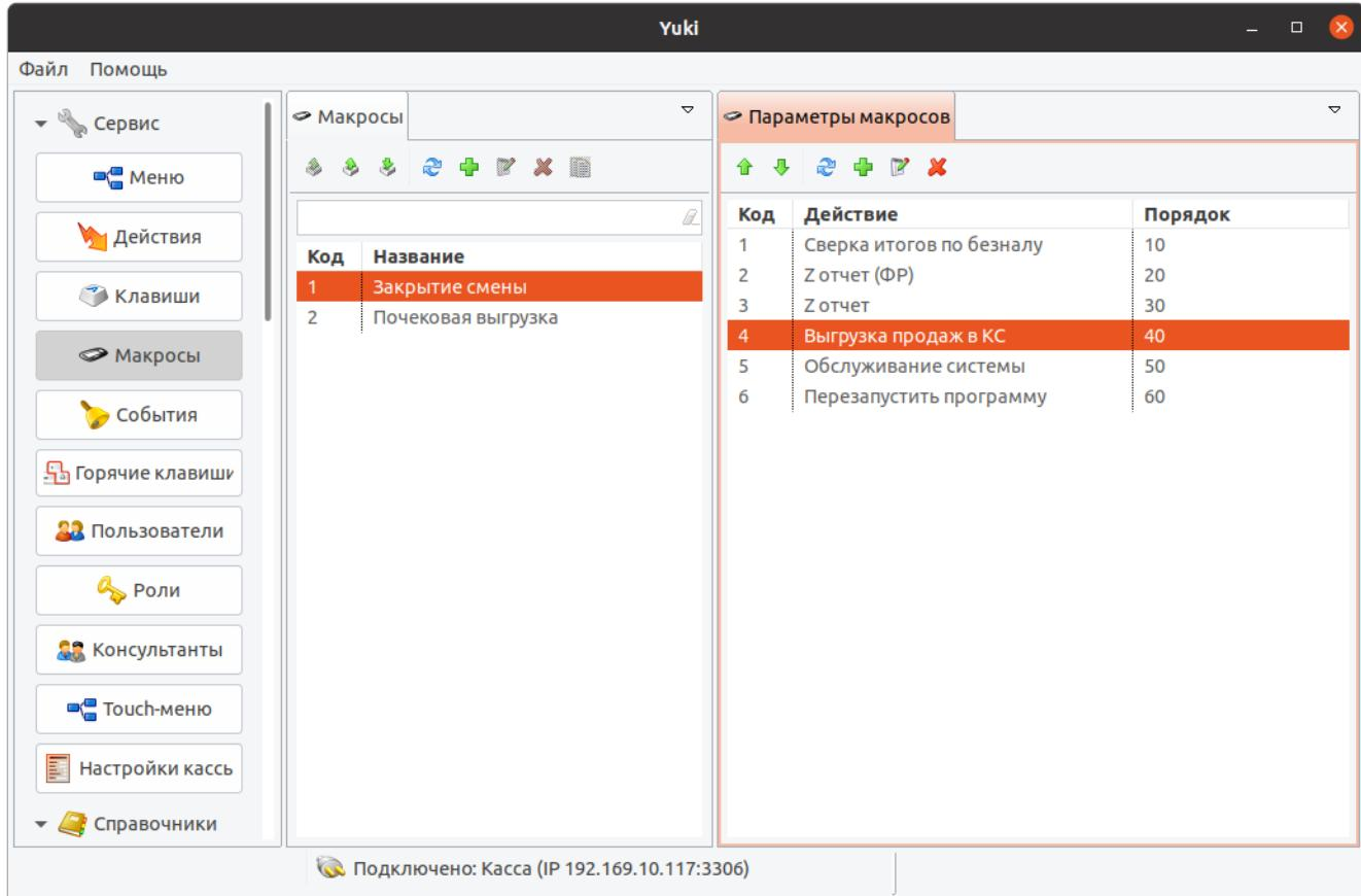
Действие "Выгрузка продаж в КС" задается командой COMMAND\_OPERATION. О настройке действий подробнее можно прочитать в разделе "[Настройка действий](#)".
