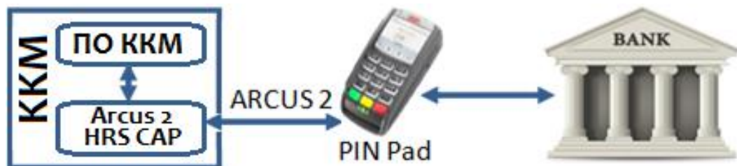
Рис. 5. Схема работы ARCUS 2 HRS CAP
